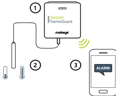
Der Mobeye CM4200 misst kontinuierlich die Temperaturwerte. Der Alarmwähler sendet sofort eine Benachrichtigung wenn es zu kalt oder zu heiß wird. Auf diese Weise haben Sie die volle Kontrolle.
