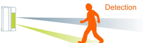
Alarm, wenn der obere und untere Detektionsbereich ausgelöst wird.
