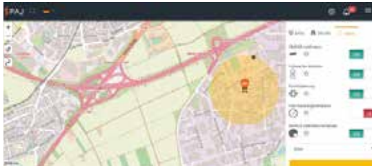
Tracker-Steuerung: Bei Verlassen des gelben Kreises alarmiert das Gerät per Mail. Rechts: Alarmmeldung bei Erschütterung
