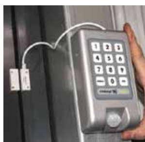
Das mobile GSM-Alarmsystem Mobeye i110 kommt ohne Netzstrom, Telefon und W-Lan aus
